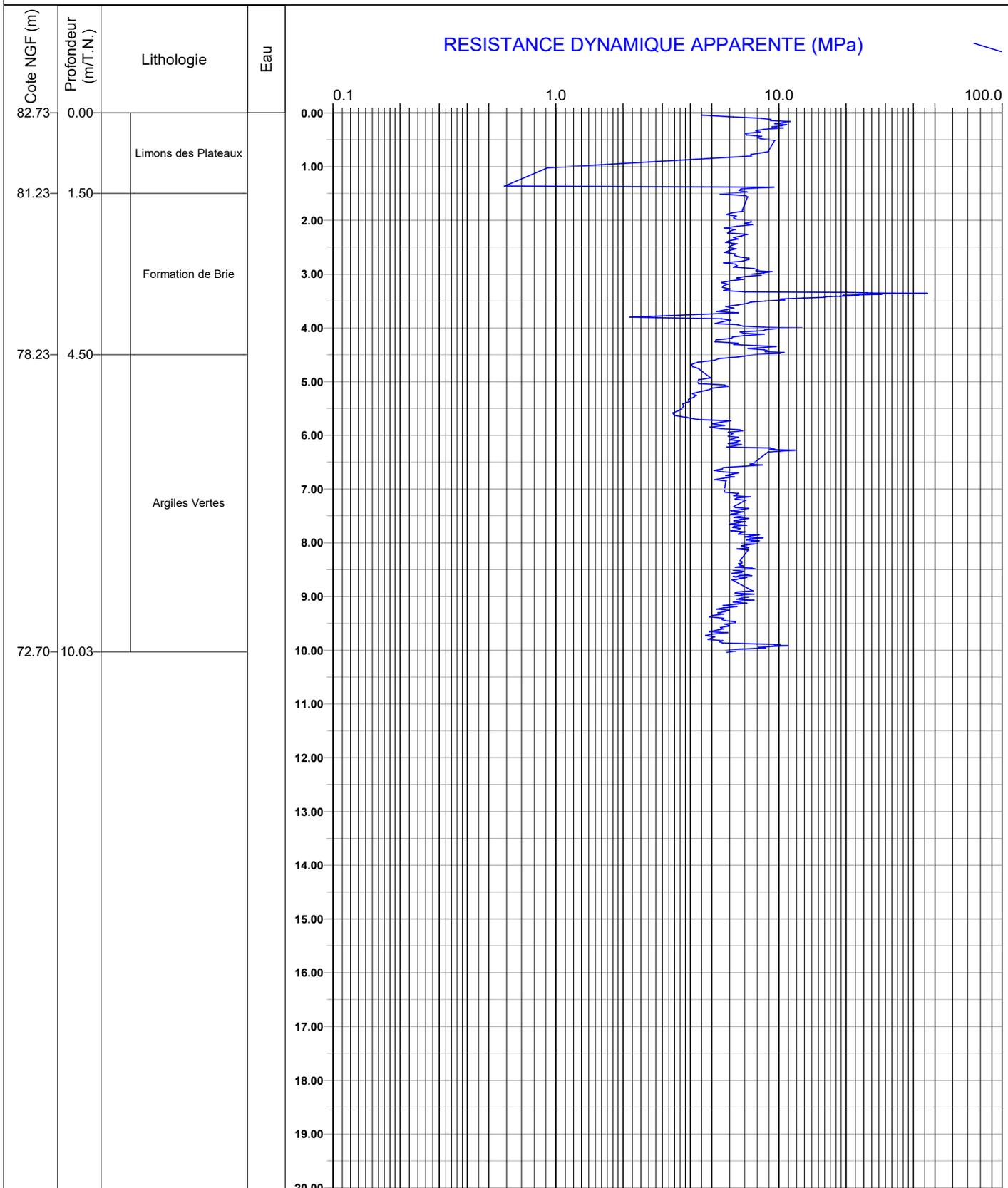
**Caractéristiques du pénétromètre GTR790**
